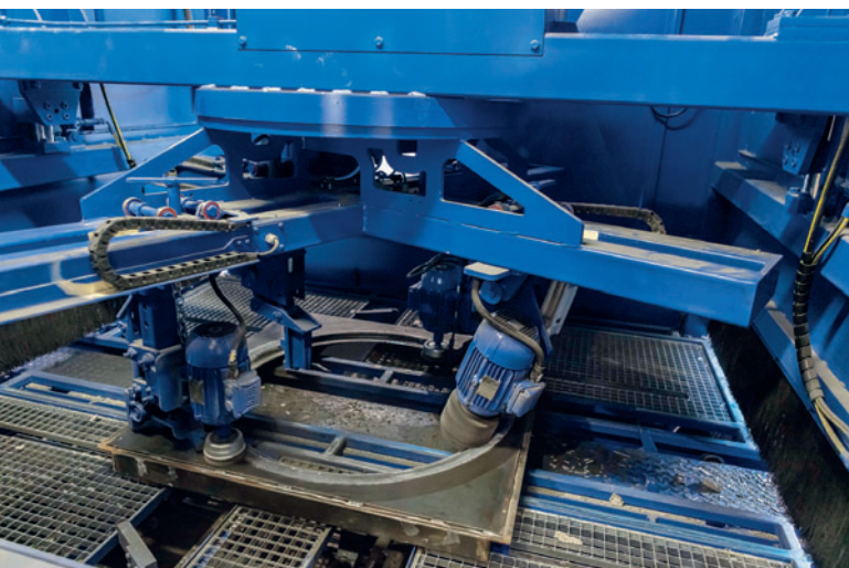
Станция очистки нижних поддонов, которая является ключевой особенностью систем паллетирования Schlüsselbauer, наряду со станциями смазки без распыления
