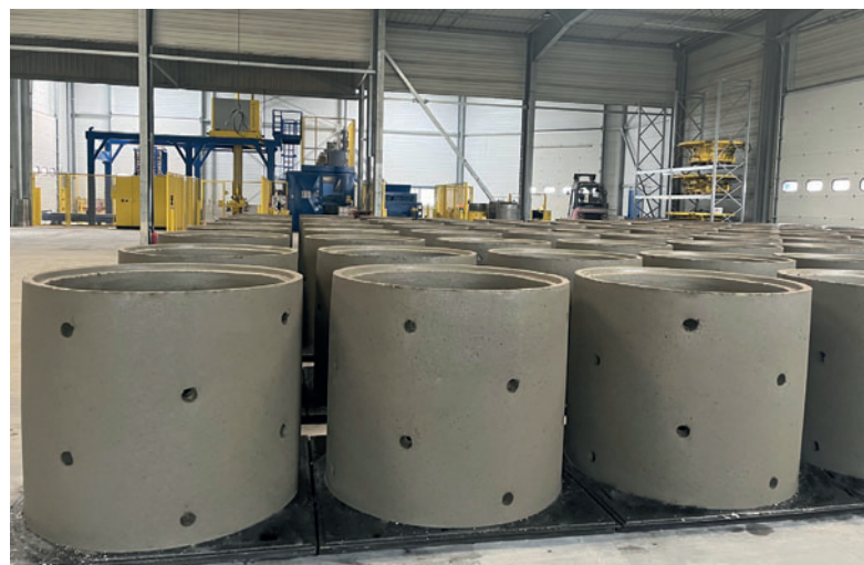
Оптимальное расположение зоны выдерживания (здесь установлены кольца с дренажными отверстиями для оттаивания воды) в цехе между производственной машиной и системой паллетирования
