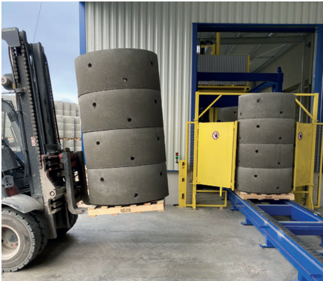
Транспортировка готовой продукции, уложенной на поддон. Конвейер идеально расположен вдоль боковой стороны здания, под навесом в защищенном месте - рядом с направляющей и внешним складом
